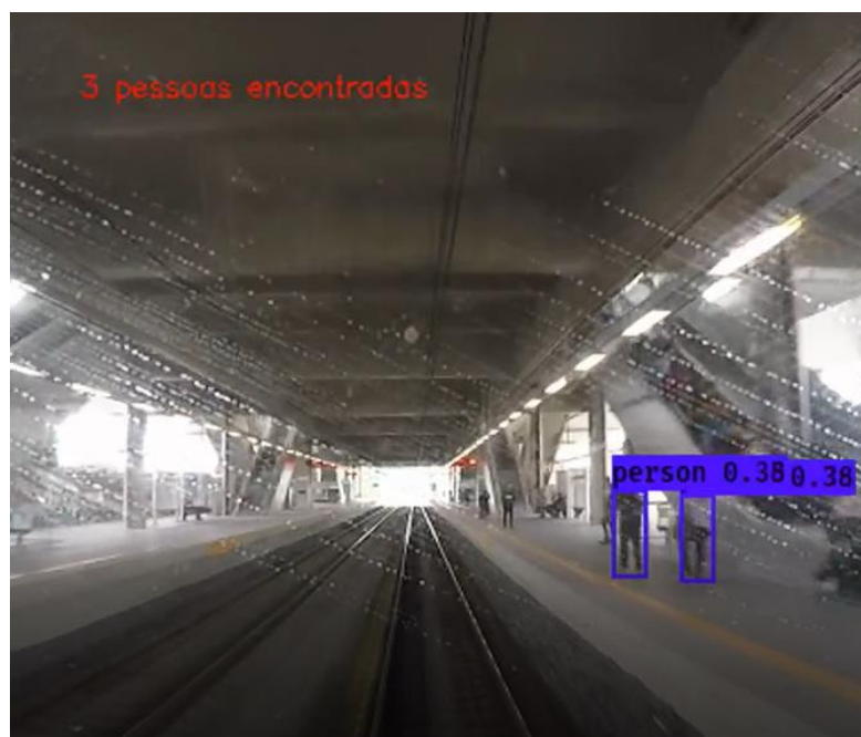
Figura 7 Detecção e contagem de passageiros nas plataformas
