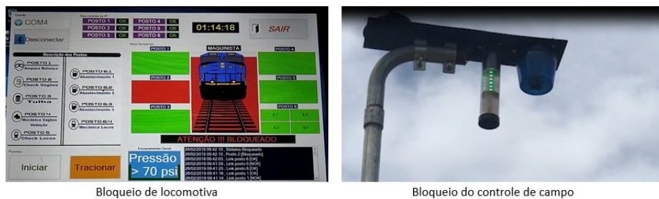
Figura 6 – Sinalização da locomotiva bloqueada para movimentação
