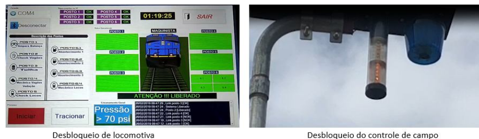
Figura 7 – Sinalização da locomotiva e controle de campo desbloqueado para movimentação
