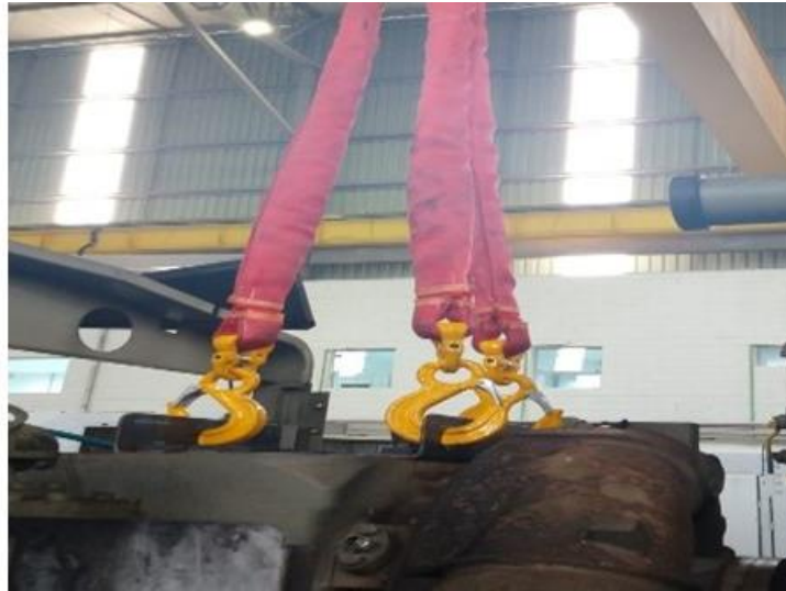
Processo de troca do turbo alimentador Fonte: Interna
