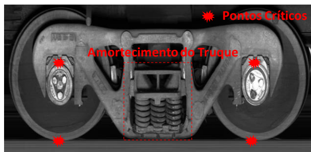
Figura 23 - Ponto críticos devido à falta de amortecimento do truque
