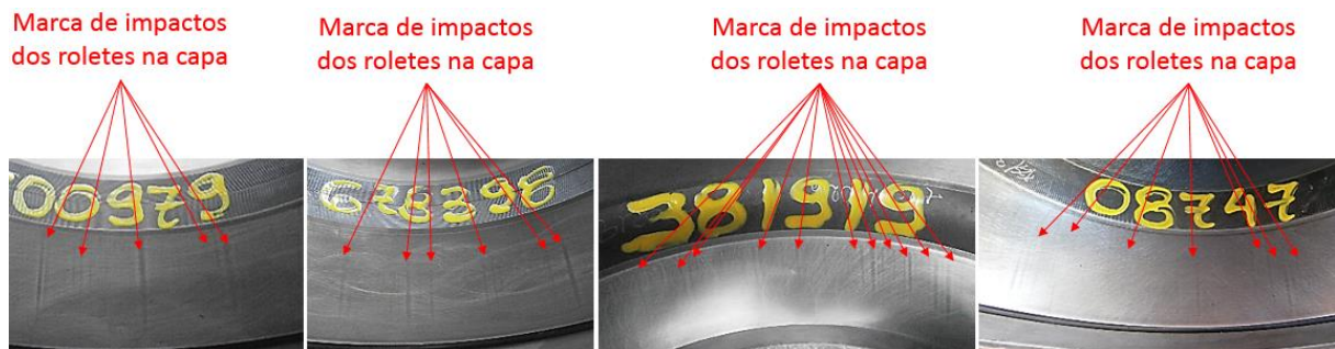
Figura 15 - Brinelamento encontrado nos rolamentos manga "T"
