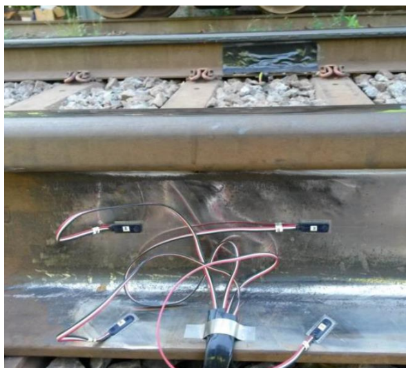
Figura 11 - Strain Gauges anexados na VIA para medição de L/V
