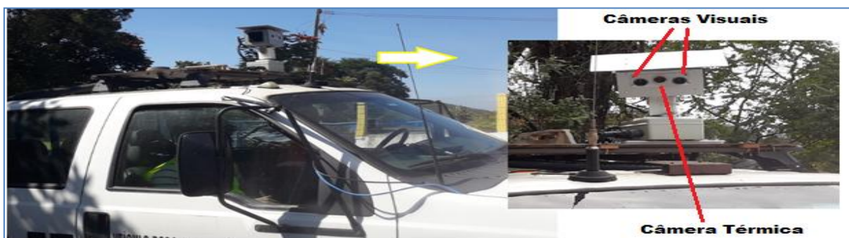
Figura 8 – Instalação do Robô no veículo rodoferroviário
