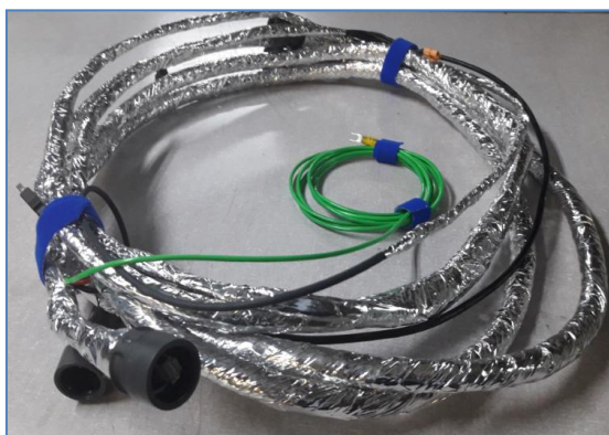
Figura 12 – Cabos blindados para interconexões
