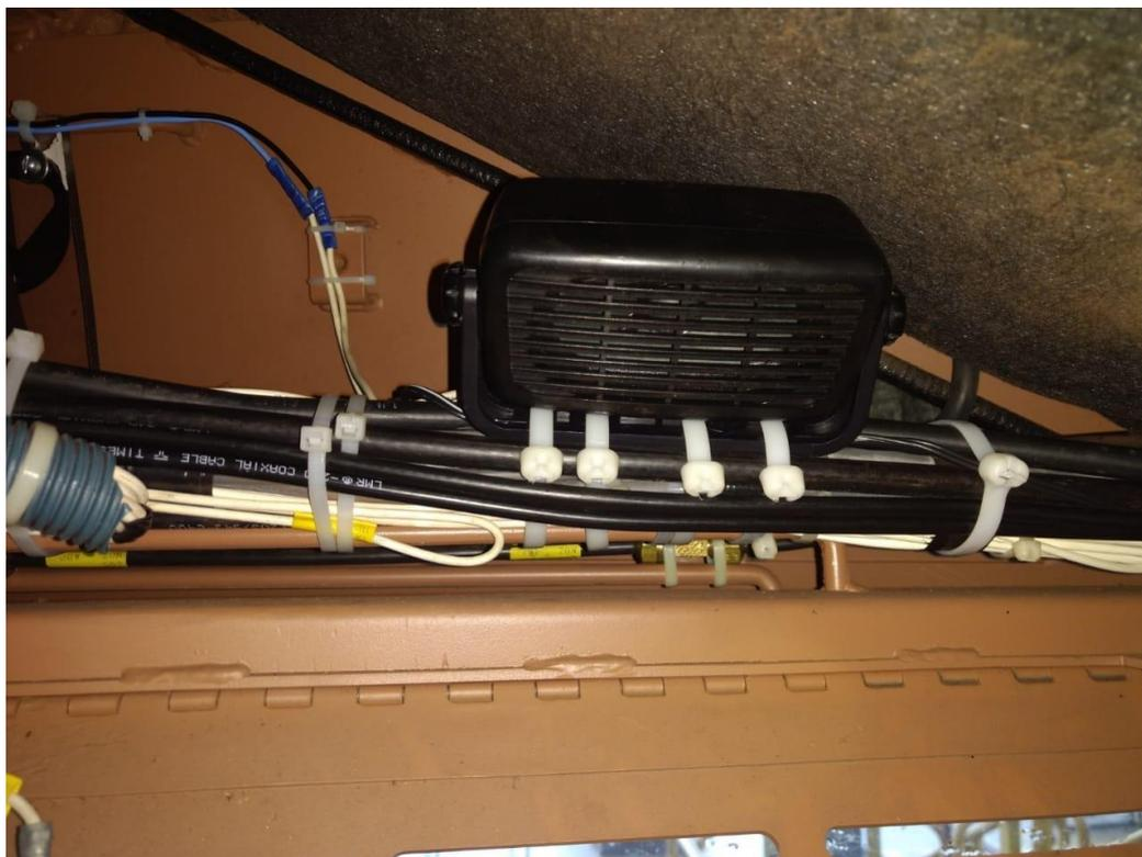
Figura 16 – Alto falante instalado no teto da cabine
