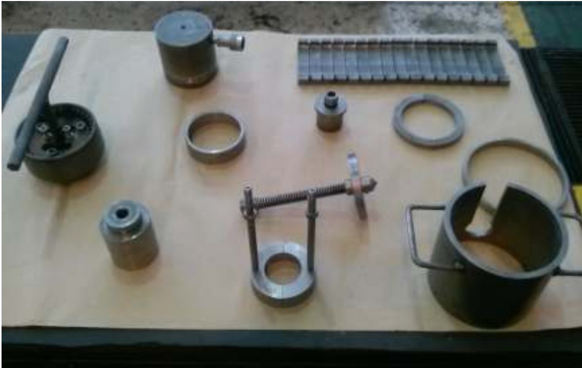
Figura 6 - Dispositivos para desmontagem e montagem de motores de tração.
