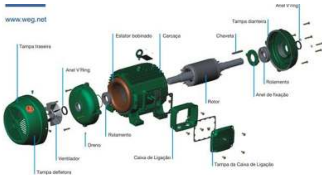
Figura 2 - Vista explodida motor WEG modelo W21. 1
