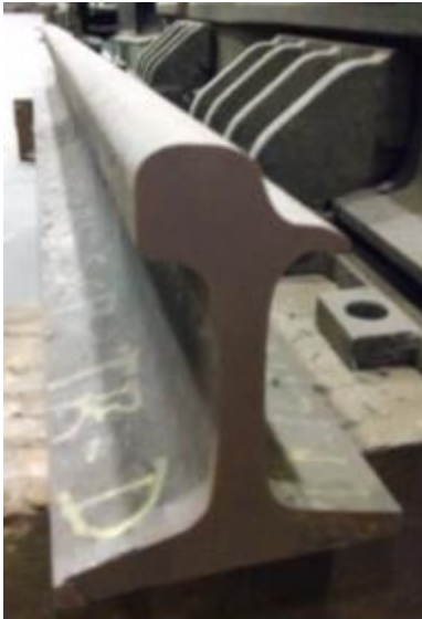
Figura 5 - Trilho com desgaste acentuado a 45º
