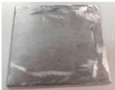
Figura 5 - Foto da chapa de aço semi-inox
