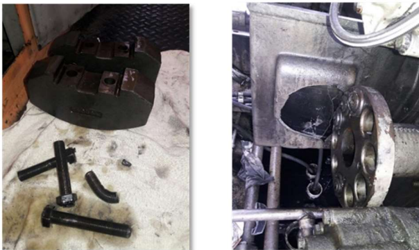
Figura 6 - Quebra do compressor da locomotiva 8133
