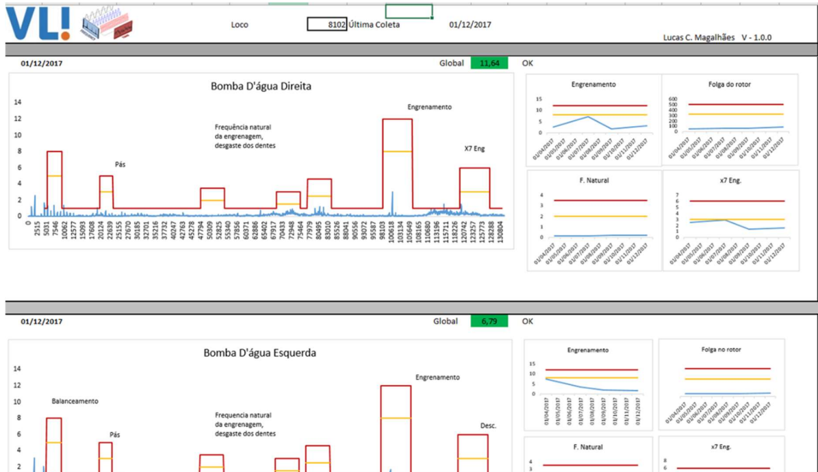
Figura 14 - software desenvolvido para realizar a análise de vibração
