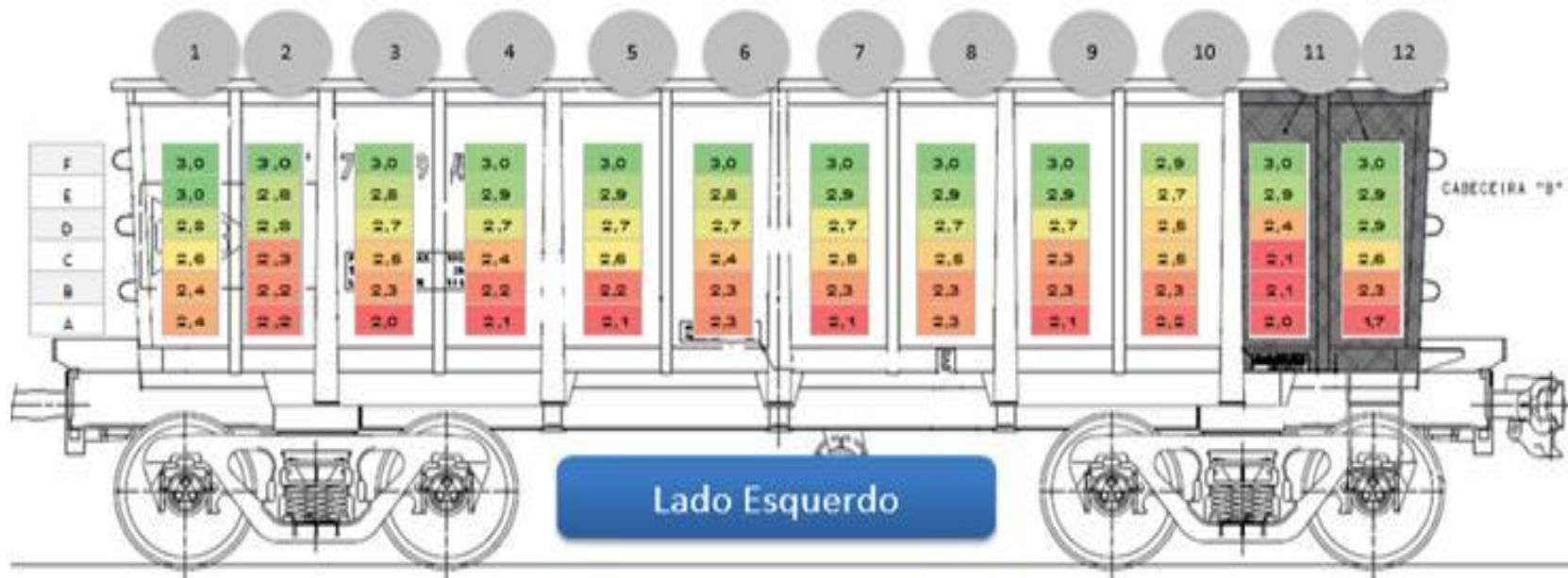
Figura 7: Subdivisões virtuais dos painéis do vagão GDT
