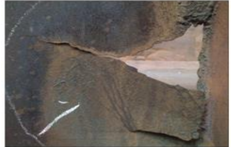
Figura 2: Chapa de vagão trincada
